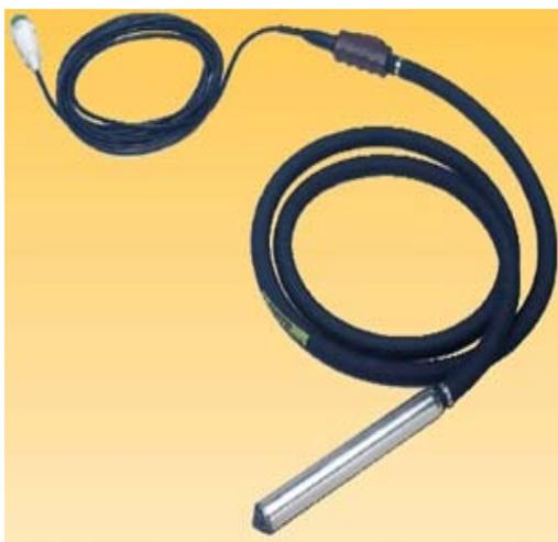
Глубинный вибратор VS370 со встроенным в наконечник электродвигателем, состоит из прочной стальной трубки и двигателя с замкнутой цепью, работающим в режиме частоты тока 200 Гц и напряжении 42В.
